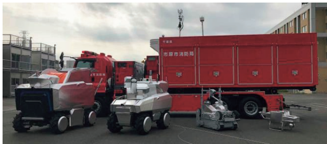
第 6-4 図 完成した実戦配備型消防ロボットシステム
