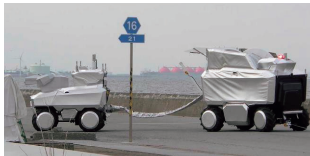
放水砲ロボットとホース延長ロボット
